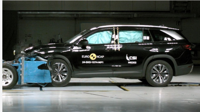
Der Škoda Kodiaq im frontalen Offsetcrash gegen die gleichschnell und versetzt entgegenrollende Barriere mit Deformationselement (Foto: Euro NCAP)
