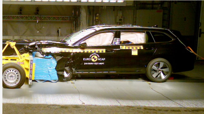
Der VW Passat im frontalen Offsetcrash gegen die gleichschnell und versetzt entgegenrollende Barriere mit Deformationselement (Foto: Euro NCAP)
