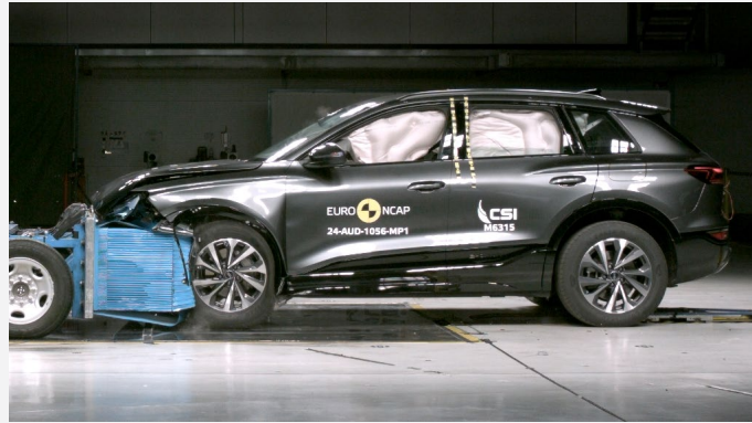
Der Audi Q6 e-tron im frontalen Offsetcrash gegen die gleichschnell und versetzt entgegenrollende Barriere mit Deformationselement (Foto: Euro NCAP)
