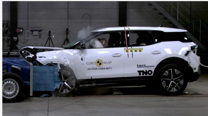
Der Ford Explorer im frontalen Offsetcrash gegen die gleichschnell und versetzt entgegenrollende Barriere mit Deformationselement (Foto: Euro NCAP)
