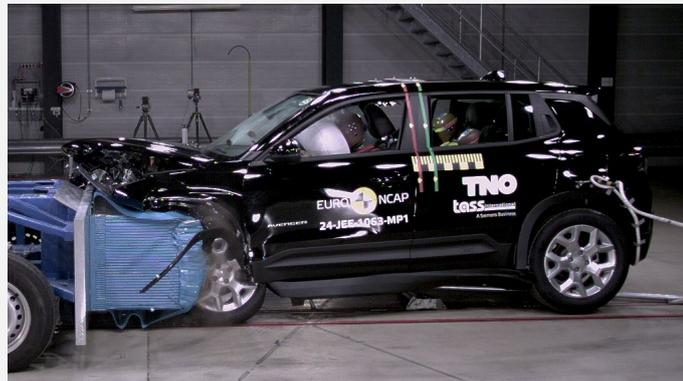
Der Jeep Avenger im frontalen Offsetcrash gegen die gleichschnell und versetzt entgegenrollende Barriere mit Deformationselement (Foto: Euro NCAP)
