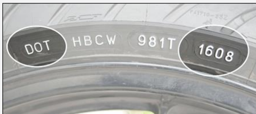
Bild 6: Die DOT-Nummer enthält viele verschlüsselte Daten, das Herstellungsdatum ergibt sich aus den letzten vier Stellen.
