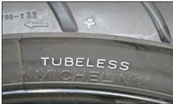
Bild 7: Bei Motorradreifen sind nach wie vor Schlauch- und Schlauchlosversionen üblich
