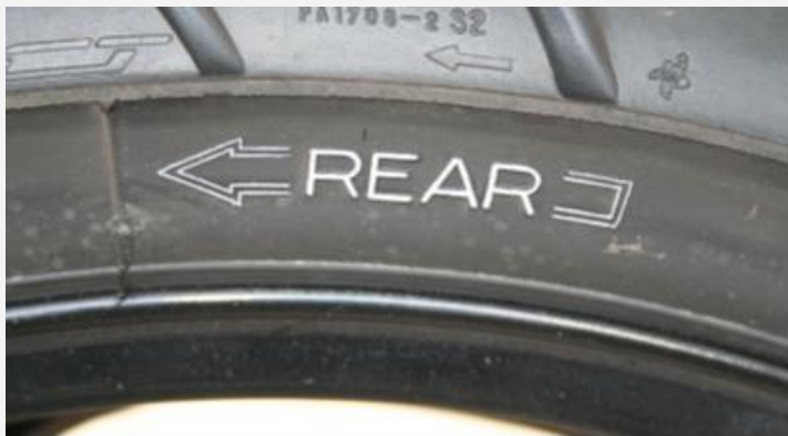
Bild 4: Der Hinweis darauf, ob der Reifen als Vorder- oder Hinterreifen verwendet werden darf.
