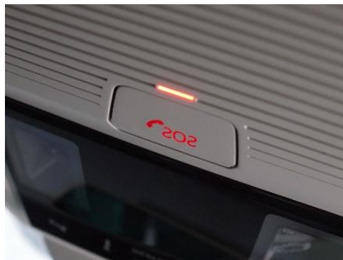
Taste für manuellen eCall. Foto: ADAC/Arnulf Thiemel
