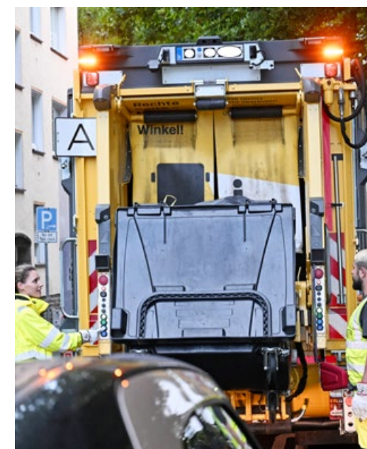
Per Knopfdruck wird der große Abfallcontainer hochgehoben, ausgeleert und wieder zurückgestellt. Die kleineren Mülltonnen mit zwei Rädern leert das Müllauto automatisch
