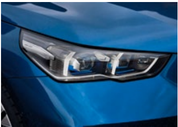
Teures Licht Scheinwerfer sind heute Hightech-Teile, die meist nicht mehr repariert, sondern ausgetauscht werden
