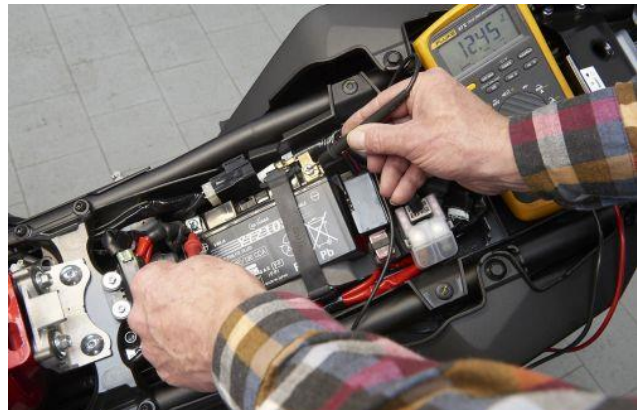
Erst unter Last zeigt die Batterie die inneren Werte. Foto: © ADAC/Uwe Rattay
