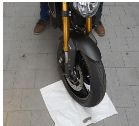
Eine Folie unter dem Vorderrad reduziert die Lenkkräfte. Defekte am Lenkkopflager lassen sich so leichter „erfühlen“. Foto: ADAC/Test und Technik
