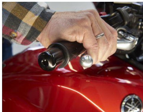
Der Bremsgriff darf sich nicht voll durchziehen lassen. Foto: : © ADAC/Uwe Rattay
