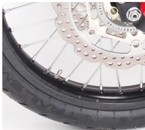
Drahtspeichen genau prüfen. Mit lockeren, fehlenden o. gebrochenen Speichen sollte nicht gefahren werden. Foto: © PR
