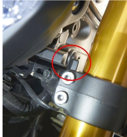
Der Lenkanschlag darf nicht gebrochen oder verformt sein. Foto: ADAC/Test und Technik
