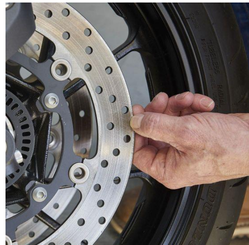
Die Nagelprobe an den Bremsscheiben. Foto: © ADAC/Uwe Rattay
