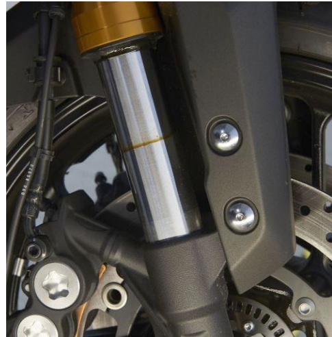
Ein Ölfilm auf dem Gleitrohr deutet auf defekte Simmerringe hin. Foto: ADAC
