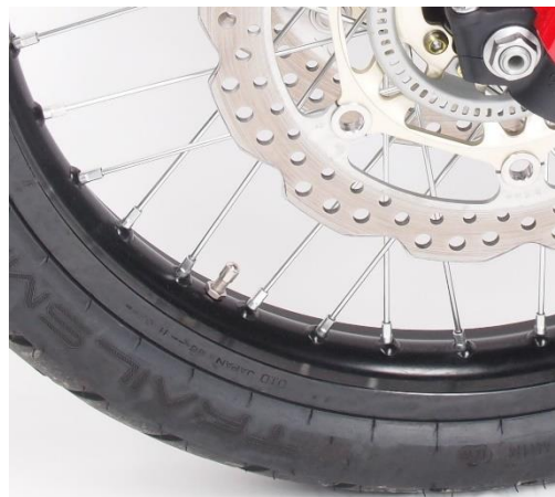
Drahtspeichen genau prüfen. Mit lockeren, fehlenden oder gebrochenen Speichen sollte nicht gefahren werden. Foto: © PR
