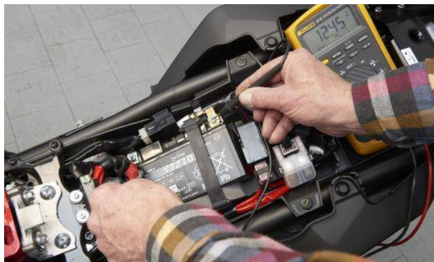
Erst unter Last zeigt die Batterie die inneren Werte. Foto: © ADAC/Uwe Rattay
