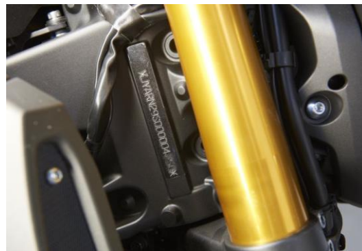
Fahrgestellnummer: Gehören Maschine und Papiere zusammen. Foto: ©ADAC/Uwe Rattay
