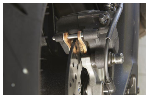
Die Nagelprobe an den Bremsscheiben. Foto: ADAC/Uwe Rattay
